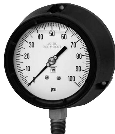
Эти инструменты изготовлены в соответствии с требованиями безопасности к конструкции и составляющим ASME B40.1.
